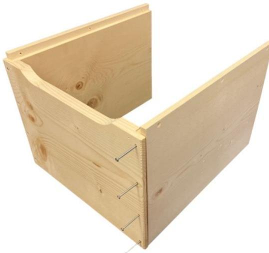
**Hinweis:** Sollte das Holz verzogen sein, legen Sie die Bienenbeute auf die Tischkante und üben Sie Druck auf die Verformung aus. Gleichzeitig verschrauben Sie die beiden Wände.
