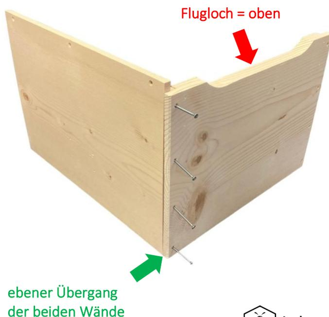
4. Befestigen Sie nun die zweite Seitenwand im gleichen Prinzip wie in Schritt 3 erläutert.
